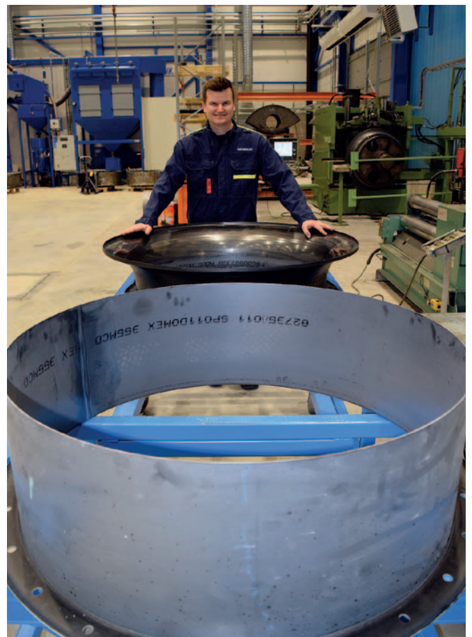
Mankelilla. Sami Unnanlahden solussa tehdään puhaltimien virtaus- ja imuosia. Mankeli pyöräyttää kappaleesta ohjelman mukaisen lieriön.
