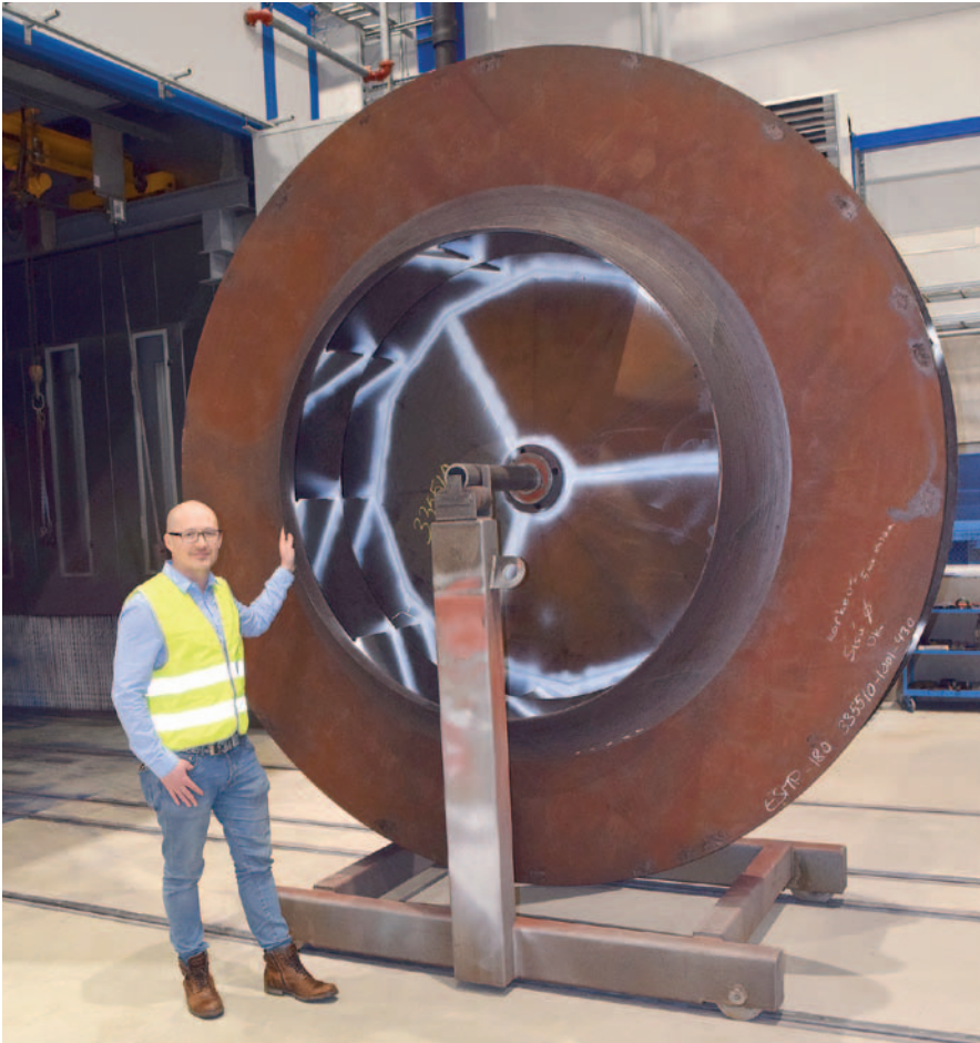
Omavarainen. Maalaamon kupeessa on parhaillaan työn alla tyypillinen keskikokoinen pyörä. Suurimmat siipipyörät ovat lähes neljämetrisiä halkaisijaltaan.
