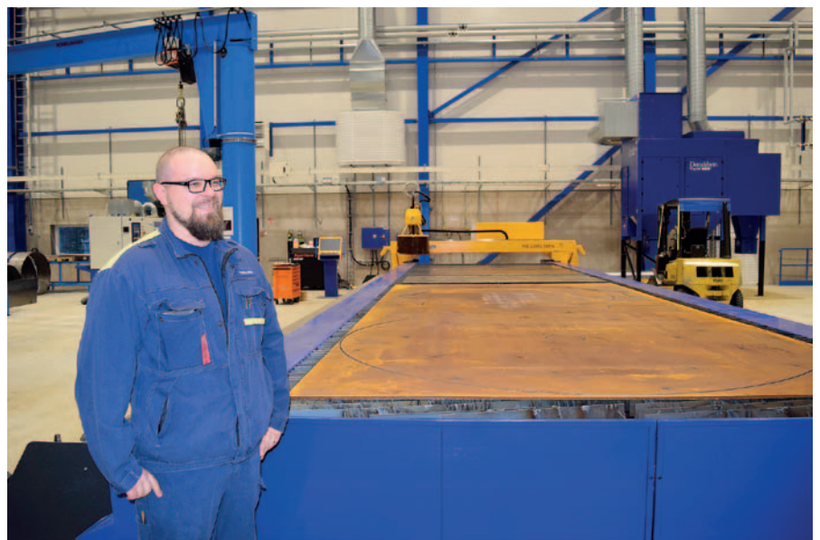
Plasmaleikkaus. Tomi Koivu toimii operaattorina hienosädeplasmalla. Työn alla oleva puhalltimen siipipyörän takalevy on halkaisijaltaan lähes kolme metriä.
