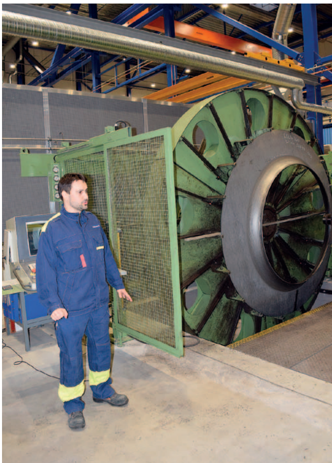
Valssausta. Seuraavalla työpisteellä Petteri Saukoniemi valmistaa imukartiota. Edellisissä kohteissa leikatut palat saavat tässä lopullisen muotonsa.
